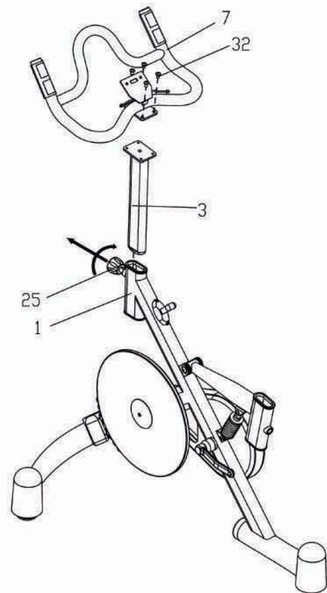
**步骤 2:** 将弹销旋钮(25)向左转放松并向后拉, 使把立管(3)可顺利插入主架(1)中; 弹销旋钮插入把立管(3)的调位孔中, 并以顺时针旋紧弹销旋钮(25); 最后将车把结合(7)放在把立管(3)上, 并以螺钉(32)将之锁紧在车把结合(7)上。
