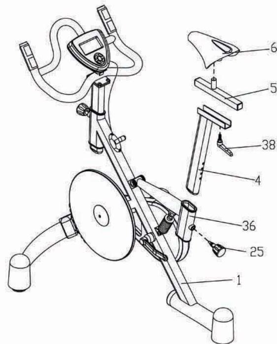
**步骤 4:** 先把鞍管竖管结合(4)插入主架(1)上的后立管结合(36)里, 调整到适当位置后用弹销旋钮(25)锁紧, 再用L形锁紧手柄(38)、垫片(39)把鞍管横管锁紧在鞍管竖管结合(4)上, 最后将鞍座(6)插入鞍管横管(5), 将鞍座调平调正后, 将其锁紧。
