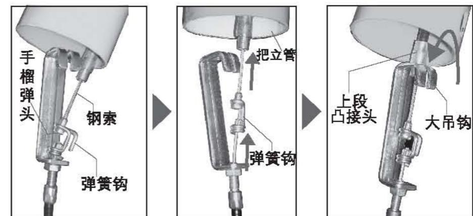
将上段微调钢索末端的手榴弹头挂在下段微调接线的弹簧钩上
